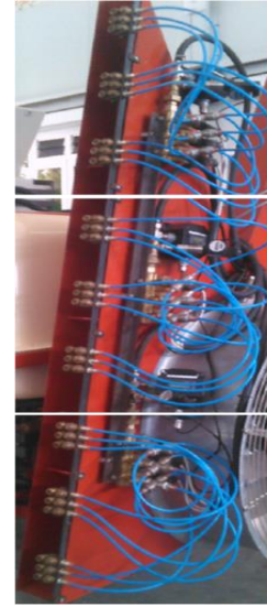
Figura 2. Barra portaboquillas con sistema de control y sensores para adquisición de datos
