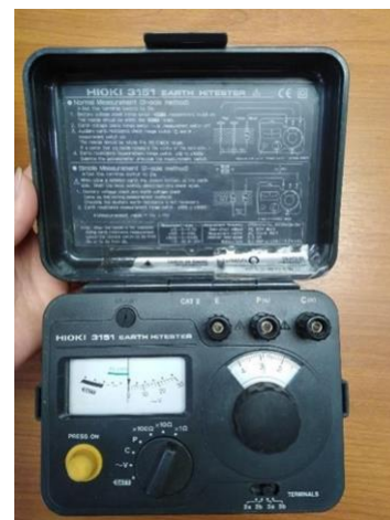
Figura 1. Telurómetro analógico HIOKI “3151 EARTH HiTESTER”.
