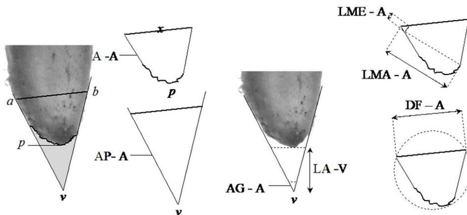
**Figura 1.** Extremo del ápice (p); vértice (v); A-A: área del ápice; AP-A: área proyectada del ápice; AG-A: ángulo del ápice; LA-V: longitud del ápice al vértice del ángulo; LME-A: longitud del eje menor del ápice; LMA-A: longitud del eje mayor del ápice; DF-A: diámetro Feret del ápice
