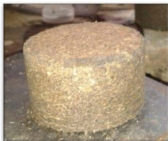
Figura 4. Briqueta combustible a partir de broza de café.
