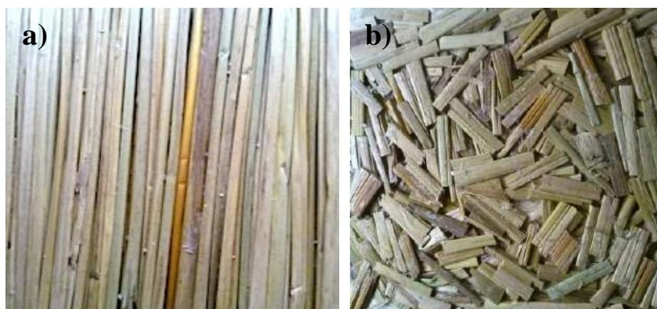
**Figura 3.** Paneles aislantes de totora de tamaño de fibra a) de 30,0 y b) de 3,0 cm (aglomerados).
