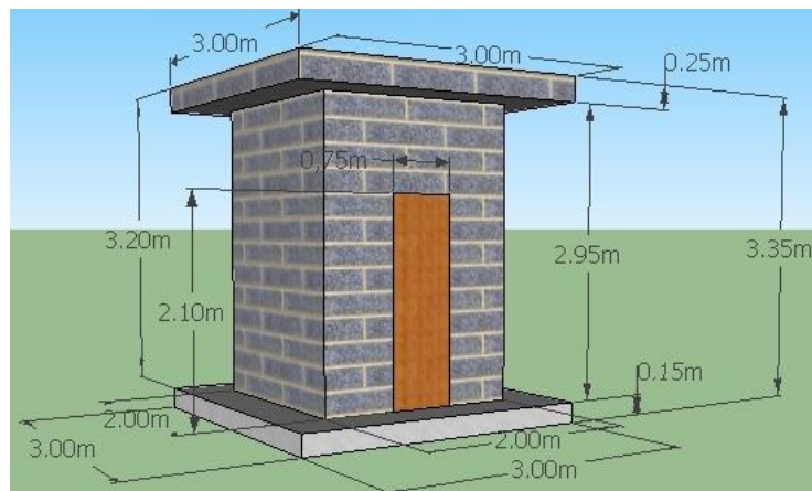
Figura 3. Módulo B. Prototipo de bloques aligerados con arcilla expandida. Fuente: los autores
