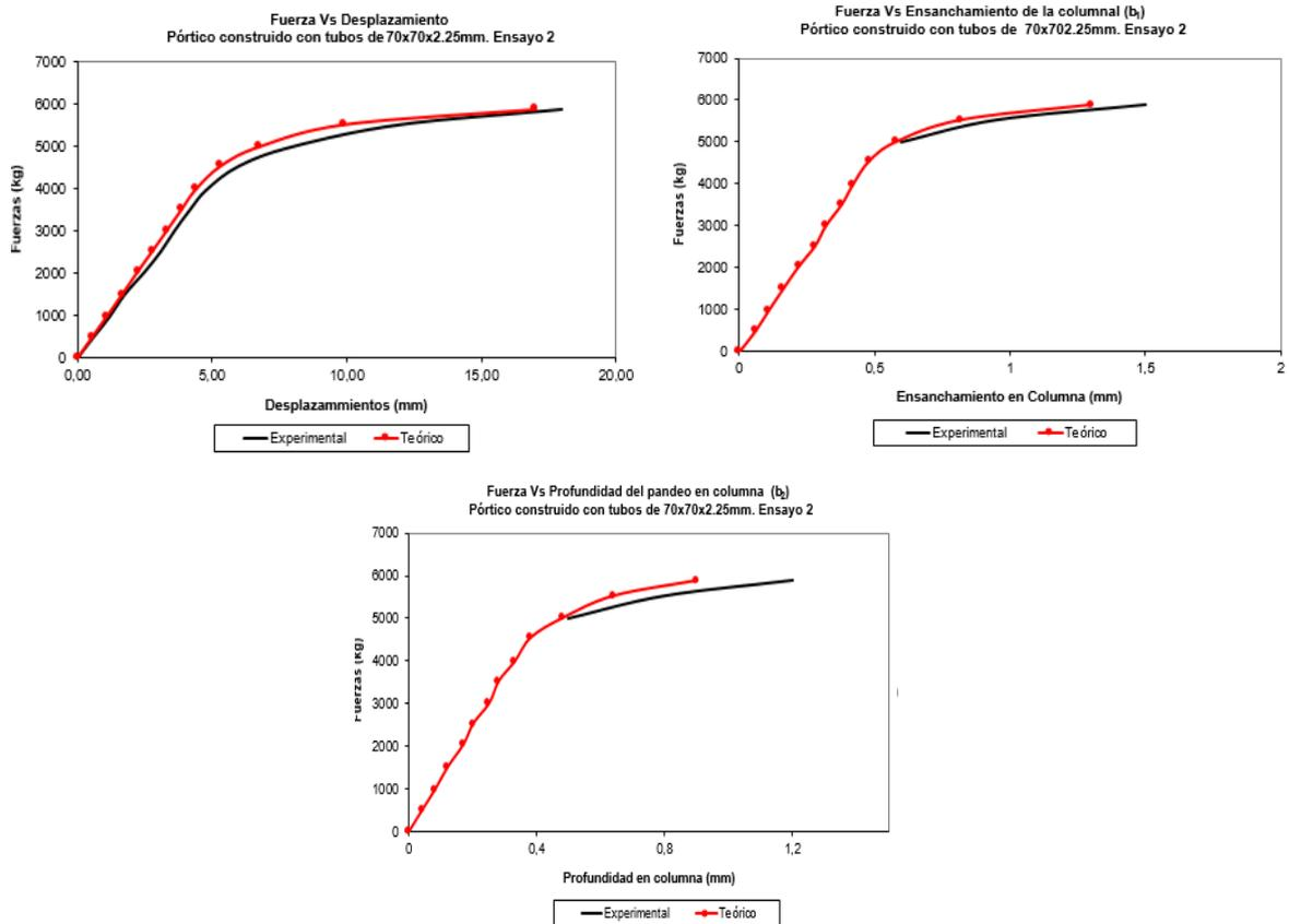
Figura 13. Comparación teórica – experimental del comportamiento de la conexión soldada tubos 70x70x2,25mm. Ensayo 2. Fuente [8]
