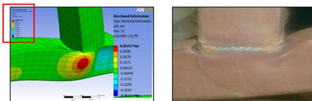
Figura 17. a) Distorsión teórica 20, b) Distorsión experimental ensanchamiento de la sección transversal de la columna del pórtico parámetro llamado  $(b_1)$  tubos de 90x90x2.50mm. Ensayo 3. Fuente: [8]
