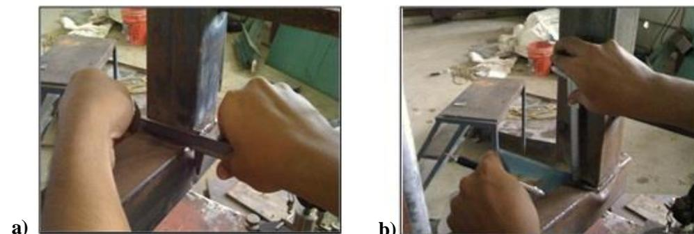
**Figura 8.** a) Ensanchamiento de la sección transversal de la columna del pórtico (b<sub>1</sub>), b) Profundidad del pandeo local de la sección transversal de la columna del pórtico (b<sub>2</sub>) Fuente: [8]
