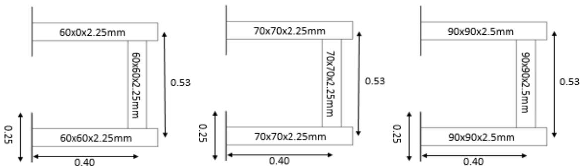
Figura 4. Geometría de los pórticos ensayados Fuente: [8]
