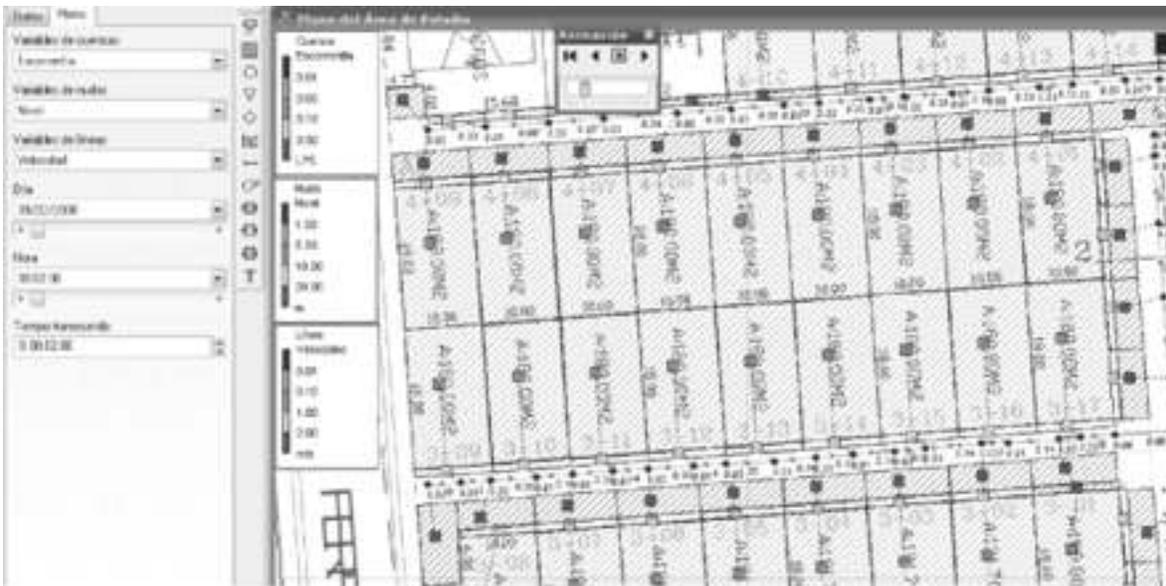
Figura 4. Respuesta de cuencas, nodos y líneas a evento de diseño al evento de diseño, obtenidos mediante el método de la onda Dinámica por el modelo SWMM 5.0
