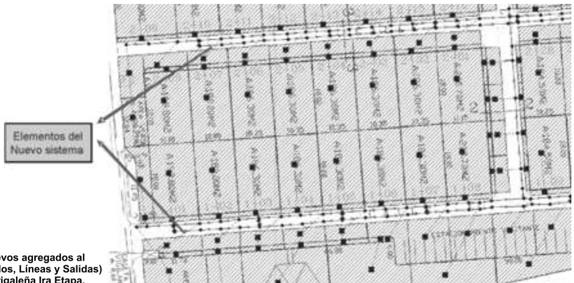
Figura 6. Elementos nuevos agregados al sistema de drenaje (Nodos, Líneas y Salidas) de la Urbanización La Trigaleña Ira Etapa.
