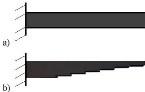
Figura 9. Configuración: a) Viga en voladizo de diseño tradicional; (b) Viga en voladizo optimizada. Fuente: [38]
