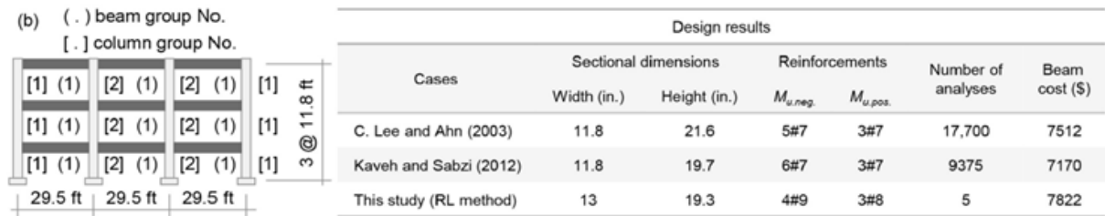
Figura 14. Casos típicos de diseño basado en IA generativa. b) caso de diseño de una estructura de marco de concreto. Fuente: [19]
