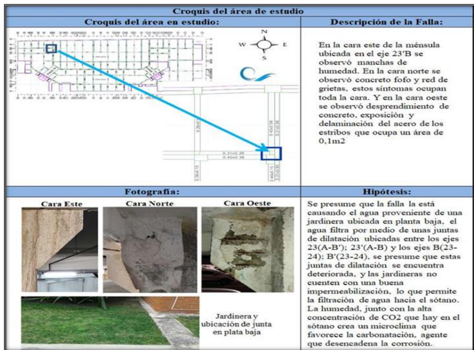
Figura 6. Sintomatología de falla de ménsula 23'B. Fuente: [7]
