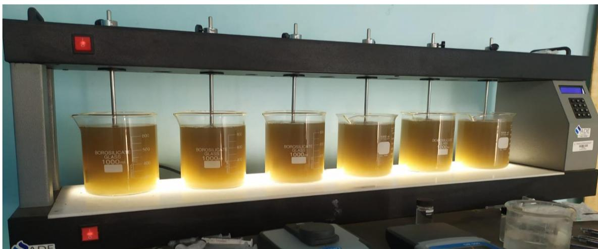
Fig. 2 Ensayos de test de jarras para la determinación de la mejor dosis de cada uno de los coagulantes empleados.
