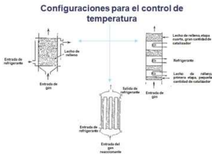
Figura 8. Medios de control de temperatura para reactores de lecho fijo
